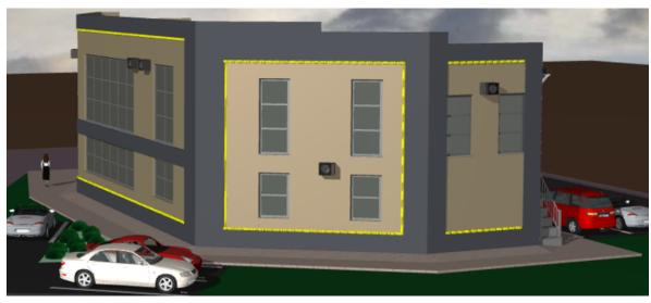
Архитектурно - художественная подсветка выполняется светодиодными светильниками мощностью 35 Вт, степенью защиты IP66, световым потоком 4619 Лм, цветовой температурой 3000 К, с прозрачным корпусом, марки FPL 01 -35 -830 устанавливаемые на фасаде здания (высоту установки уточнить поместу).
