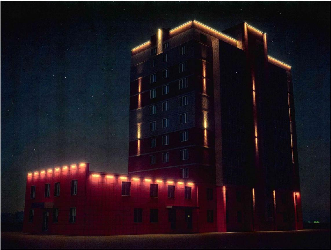
Цвет корпусов источников света должен соответствовать цвету части фасада, на которой они размещаются. Температура источников освещения 2700 – 3000К (теплый желтый свет). При подсветке фасадов используется исключительно отраженный свет.
